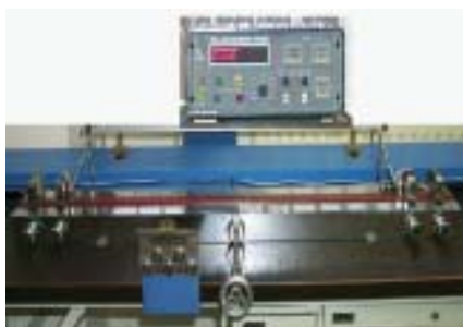
Перевірка на опір постійному струму
