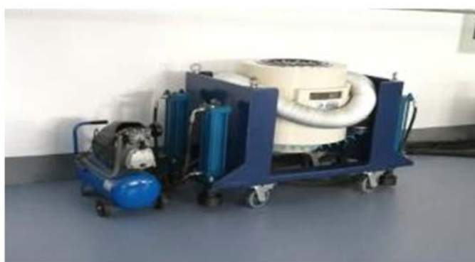
Вібраційний апарат (Оцінка поглинання вібрації)
