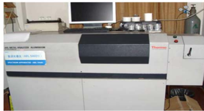
Спектрометр (ARL-MA) (Елементний аналіз)
