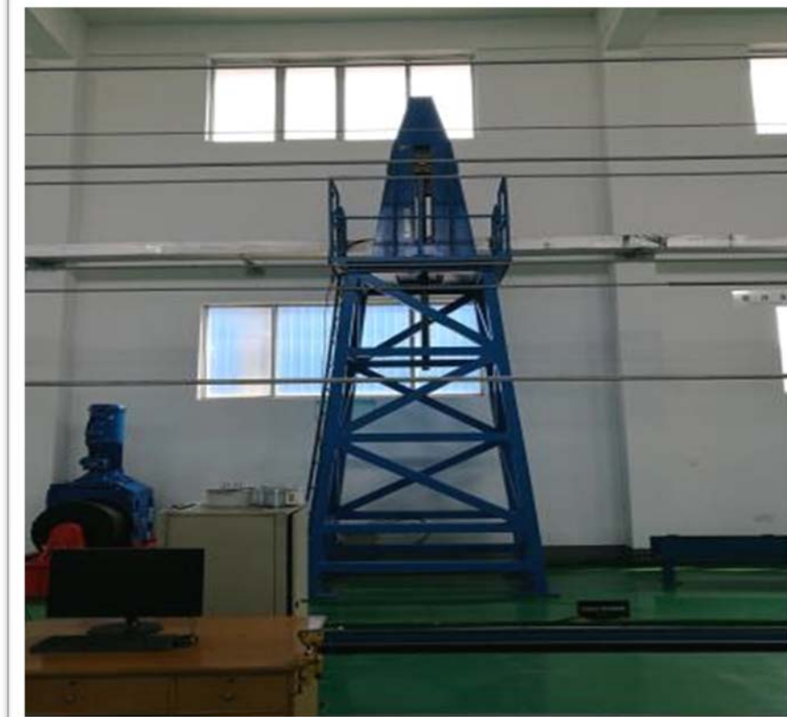
Пристрій для випробування на шків: оцінка здатності кабелю витримувати шків під час встановлення.
