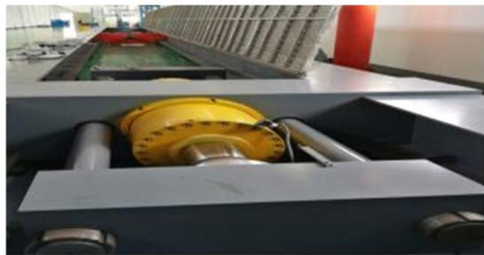
Горизонтальна машина для випробування на розтягування 300T (Розривне навантаження та напруга-деформація)
